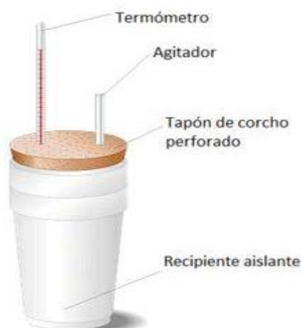
Fig. 1. Esquema de un calorímetro sencillo elaborado con vasos de unicel y corcho.
